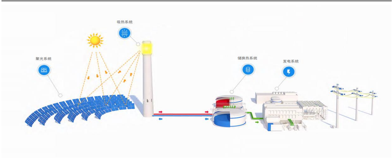
图 3：光热系统发电示意图
